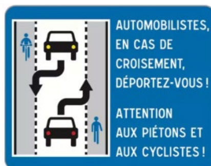
Panneau annonceur d'une chaussée à voie centrale banalisée, également dit « chaucidou »
